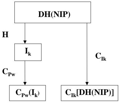
H = fonction de Hachage ; C = fonction de Chiffrement ; DH : Double fonction de Hachage
